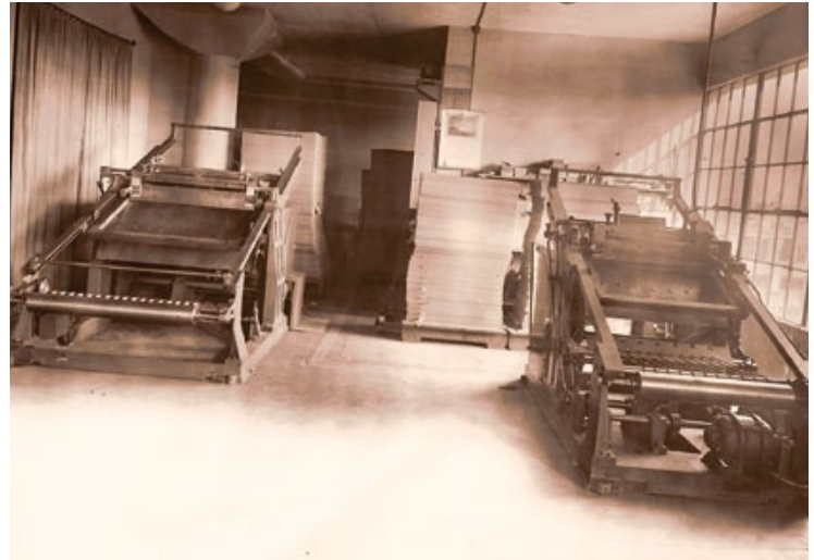
Vollautomatische Selectasine-Zylinderdruckmaschinen bei Vitachrome, vermutlich 1930er-Jahre (Firmenarchiv Vitachrome)
