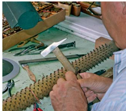
Reparieren einer Druckwalze
