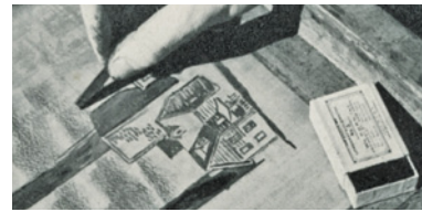
Herstellung einer Auswaschschablone: Aufzeichnen des Druckbildes
