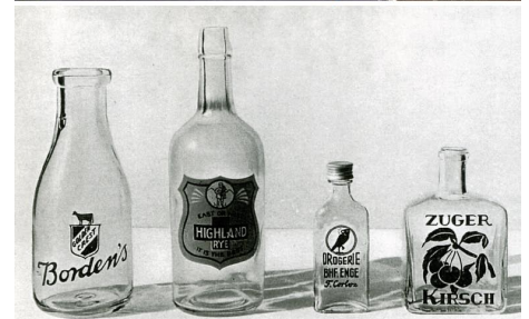
Etiquetten in eingetragten keramischen Farben direkt auf Flaschen mit Seiden-Sieb-Schablonen gedruckt, die ersten zwei von links in Amerika, die anderen zwei in der Schweiz hergestellt.
