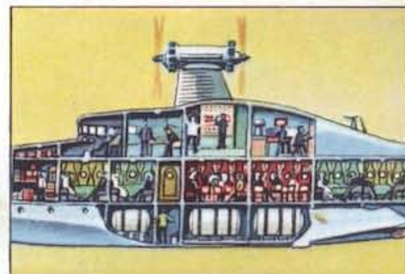
N° 3. L'avion géant „Do X“ : coupe longitudinale de la coque
