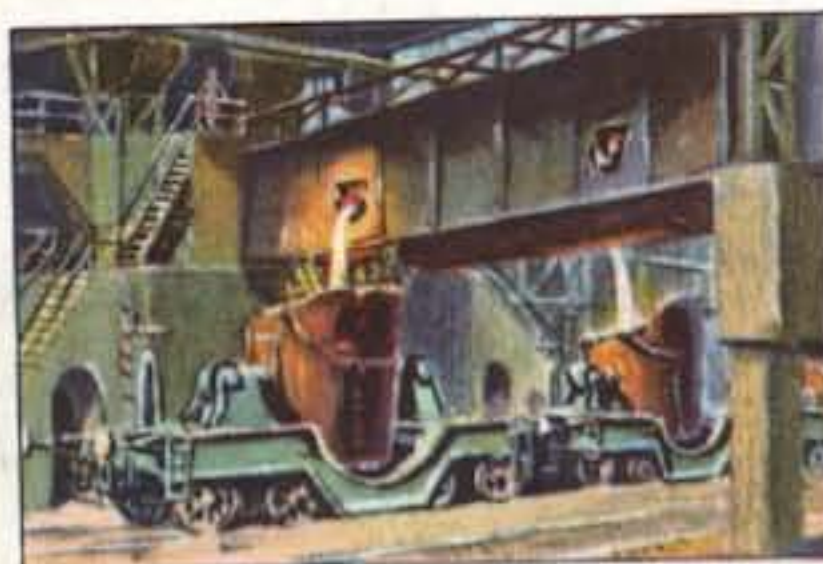
N° 7. Coulée dans un creuset mobile
